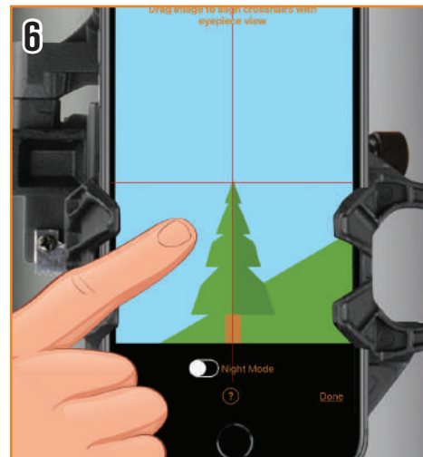
6. Faites glisser la vue de la caméra jusqu'à ce que le même objet soit centré dans le réticule de visée.
