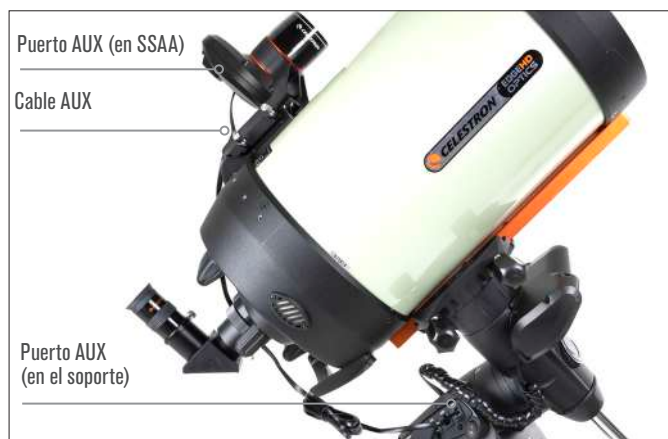
Fig. 10: Use el cable AUX incluido para conectar el puerto AUX de SSAA al puerto AUX del soporte.
