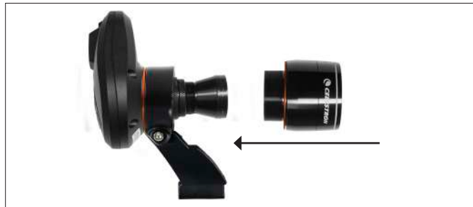
Fig. 9: Réinstallez le boîtier avant sur le SSAA. N'oubliez pas la bague cosmétique orange!
