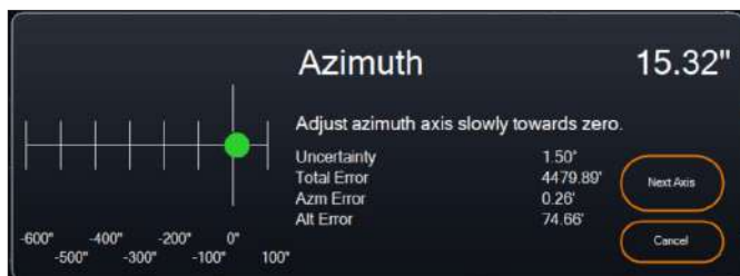
Fig. 18: Ventana de ajuste de eje de azimut durante alineación polar en CPWI.
