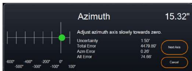
Abb. 18: Azimutachsen-Einstellungsfenster während der Polausrichtung in CPWI.
