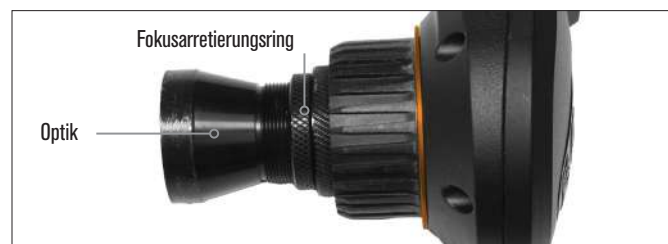
Abb. 24: Lösen Sie den Fokussiering beim Vornehmen von Fokussierungsanpassungen, ziehen Sie ihn dann fest, wenn scharf fokussiert.
