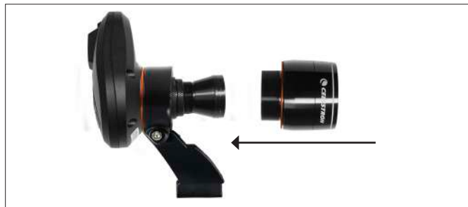
Fig. 9: Reinstallare l'alloggiamento anteriore su SSAA. Non dimenticare l'anello cosmetico arancione!
