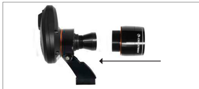
Fig. 9: Reinstale la carcasa anterior en SSAA. ¡No olvide la arandela naranja cosmética!
