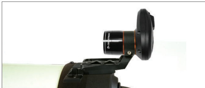
Fig. 5a: Sarà necessario installare la base e la staffa grande al contrario su un telescopio CPC 800.
