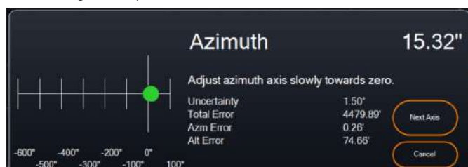
Fig. 18: Fenêtre d'ajustement de l'axe d'azimut pendant l'alignement polaire dans CPWI
